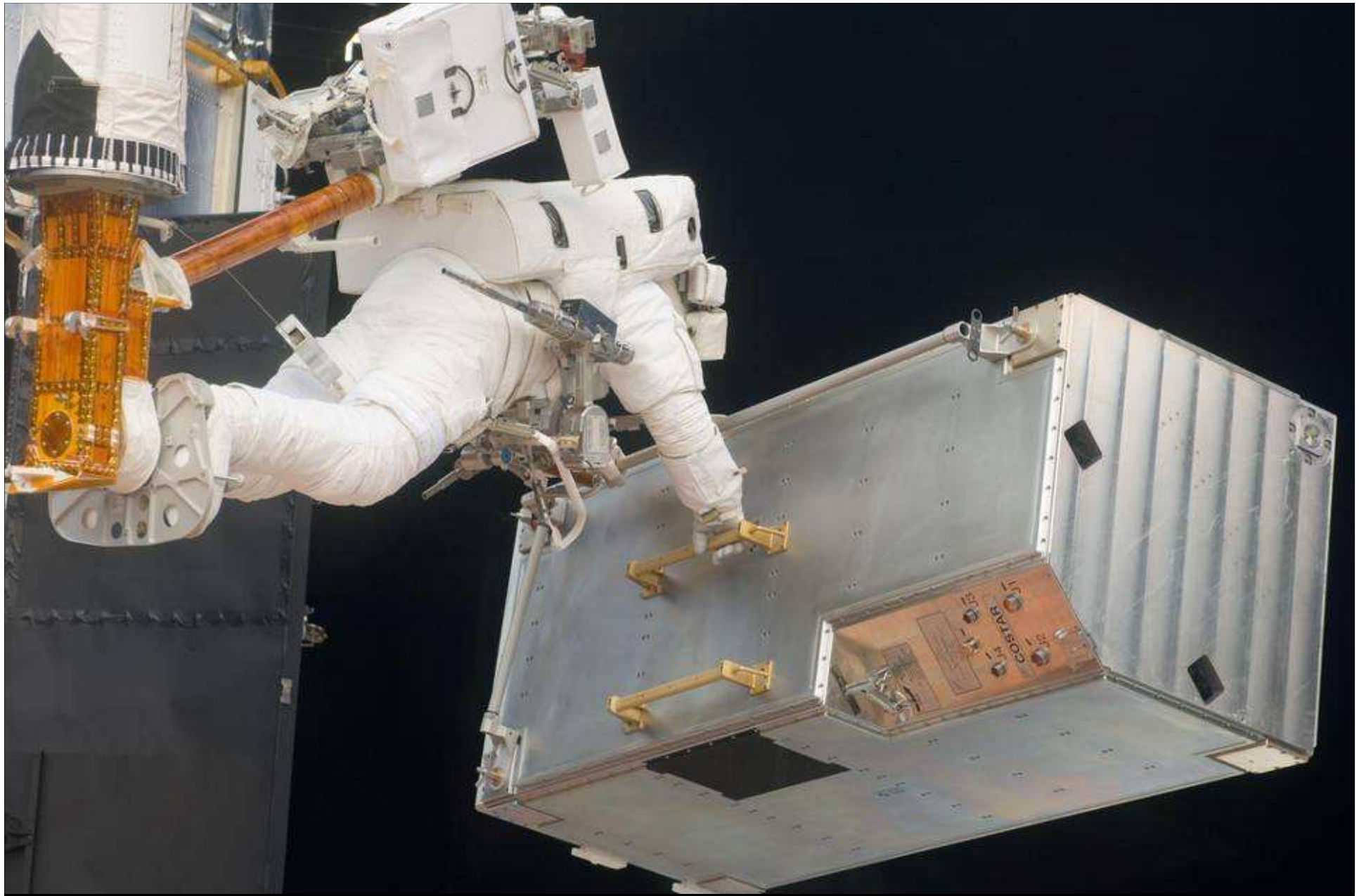
Andrew Feustel w trakcie misji mającej na celu unowocześnienie Teleskopu Hubble'a. W kontenerze znajduje się COSTAR - moduł korygujący wadę zwierciadła teleskopu.
